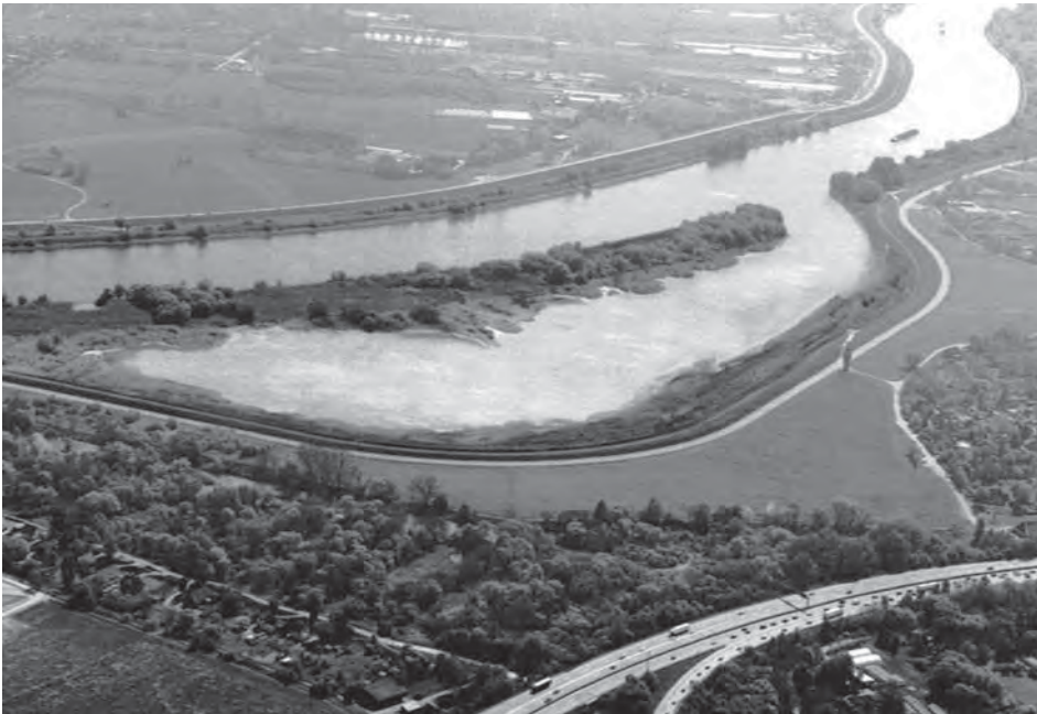
Das tidebeeinflusste Flachwassergebiet Kreetsand an der Norderelbe, im Wilhelmsburger Osten. Hier wurde bereits der Deich zurückverlegt. Foto: HPA
